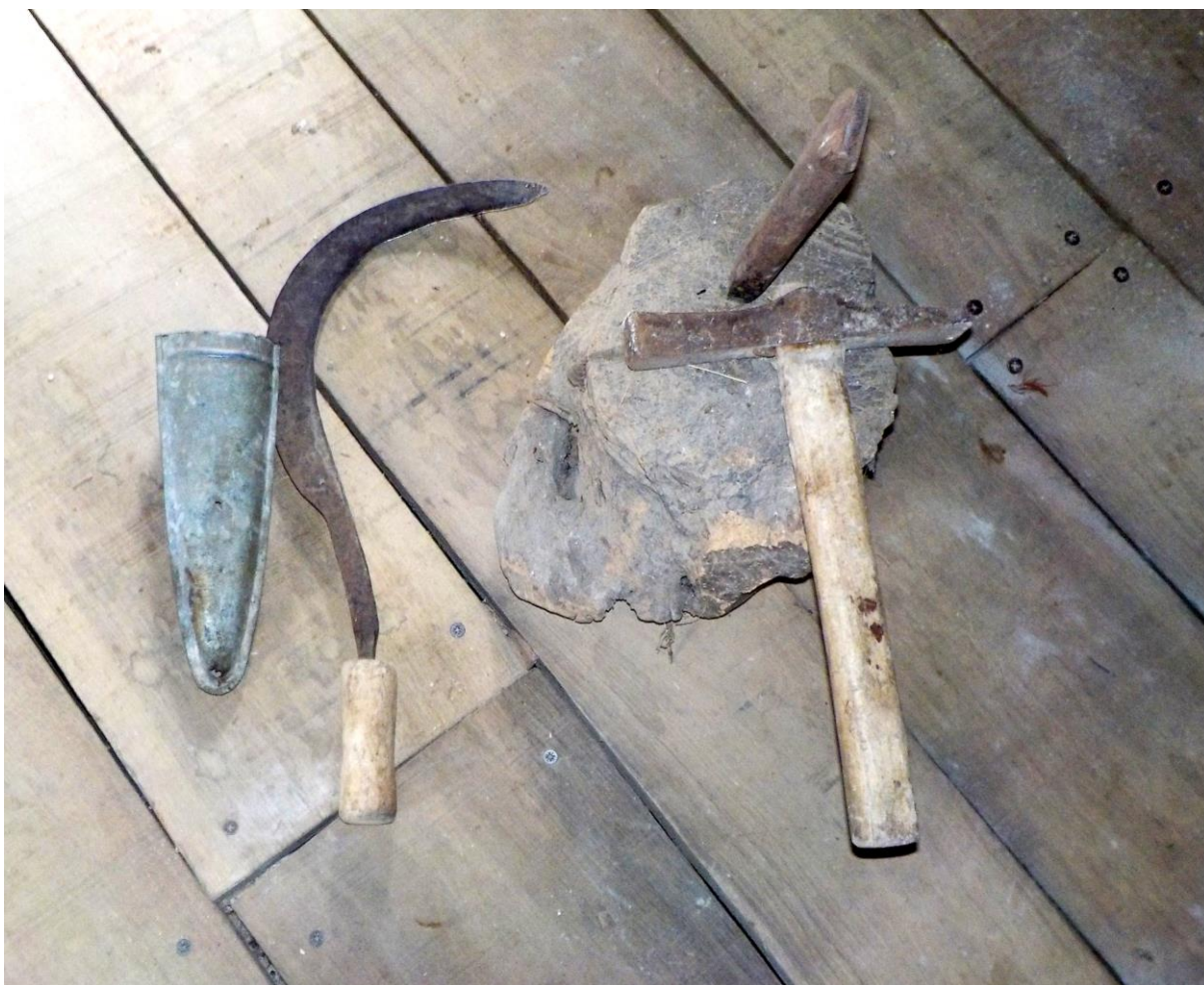
Cova en fer blanc percé sans la pierre, serpette, marteau à enchapler et enchaple. Ci-dessous, fer d'enchaple à planter dans un tronc adéquat.
