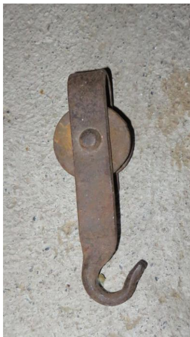
Poulie pour faire rouler les fagots sur le câble de la montagne au village. On les graissait à mort pour éviter la surchauffe.
