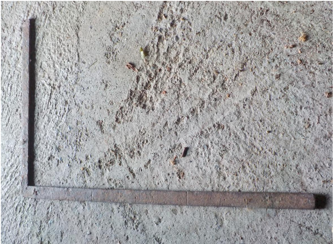
L'équerre du maçon. A retrouver la truelle et le fil à plomb.
