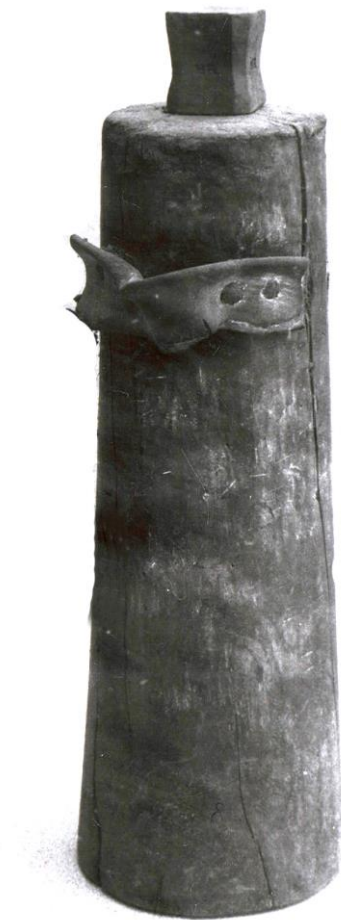
Enclume d'horloger ou de lapidaie.
