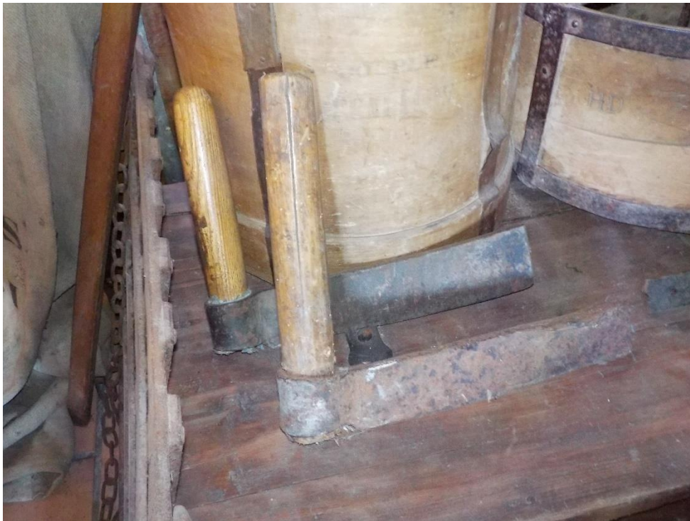
Fers à tavillons. On découvrira plus bas le banc à tavillons.
