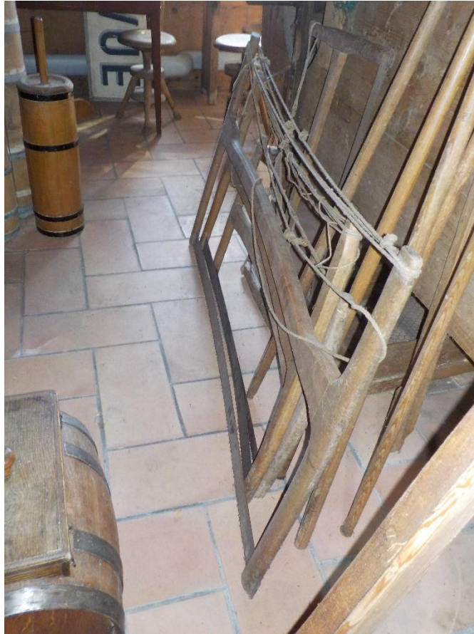
Scies à cadre de toutes dimensions mais toujours construites selon le même principe. Le bois de tension manque souvent.
