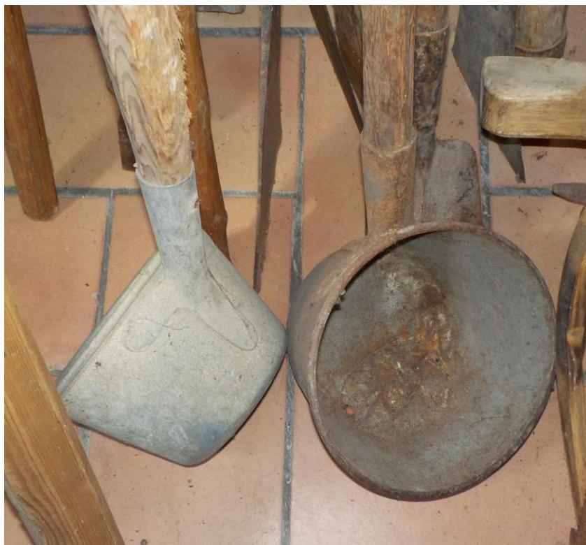
Puisoir en fer blanc. D'autres étaient en bois, droit sortis des ateliers de boisseliers. Le manche est toujours long.
