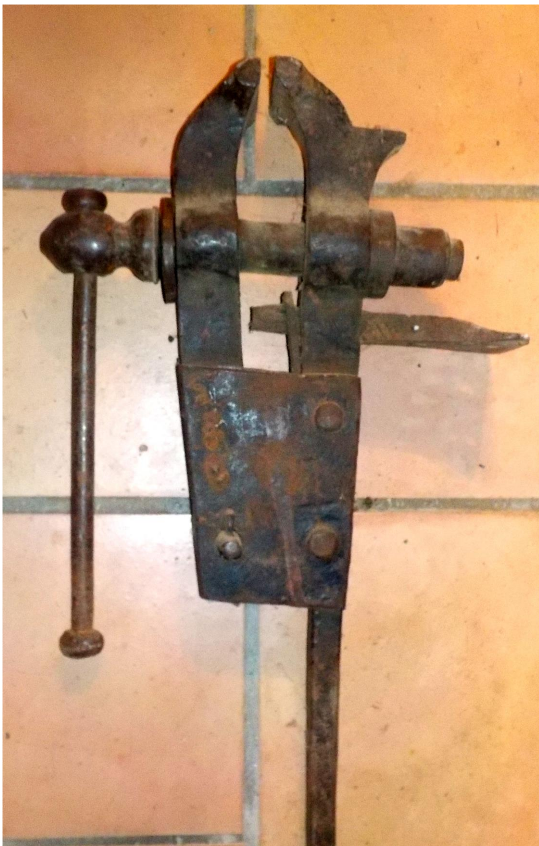
Grand étau. Le pied se prolonge et pénètre dans le sol afin d'assurer la stabilité à l'instrument.
