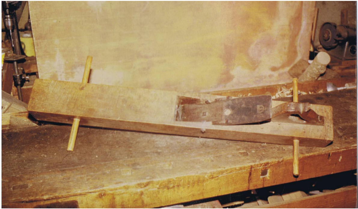
Varlope. Elle put srvir à fabriquer des pliures pour boîtes à vacherins que par ailleurs on fabriquait aussi dans la maison.
