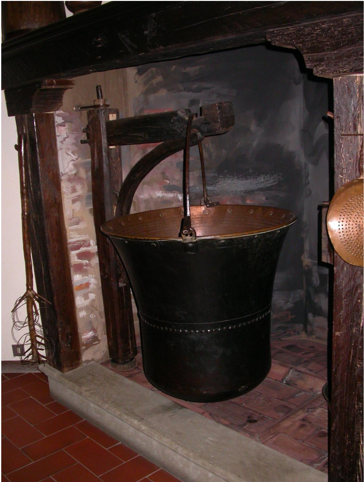
Le chaudron ou la chaudière pour la fabrication du fromage. La forme est apparemment typique du pays de Bergame. A droite la poche à lever le séré, à gauche le débattoir taillé directement dans un arbre.
