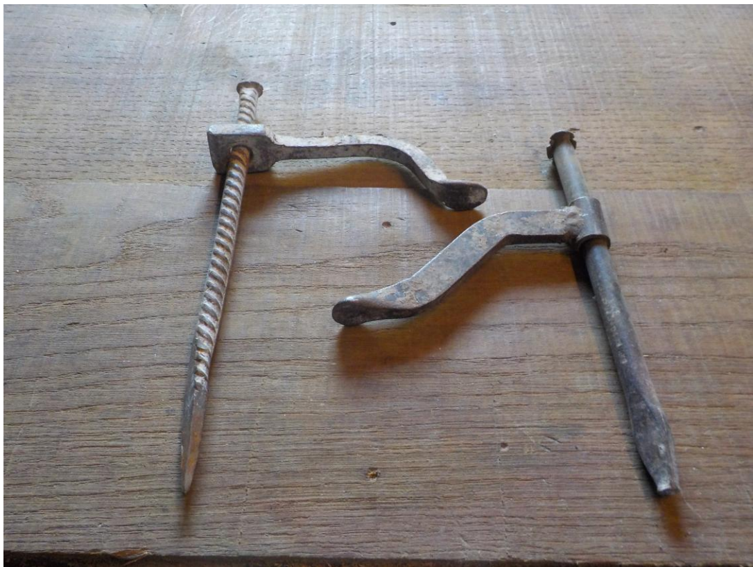
Deux « serre-joint » de maçon, l'un ramené de Suisse.
