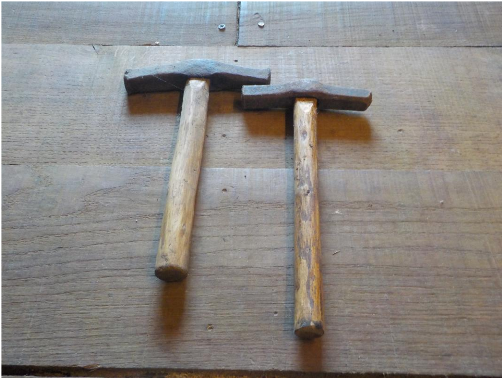
Marteau pour enclapler les faux sur le fer.
