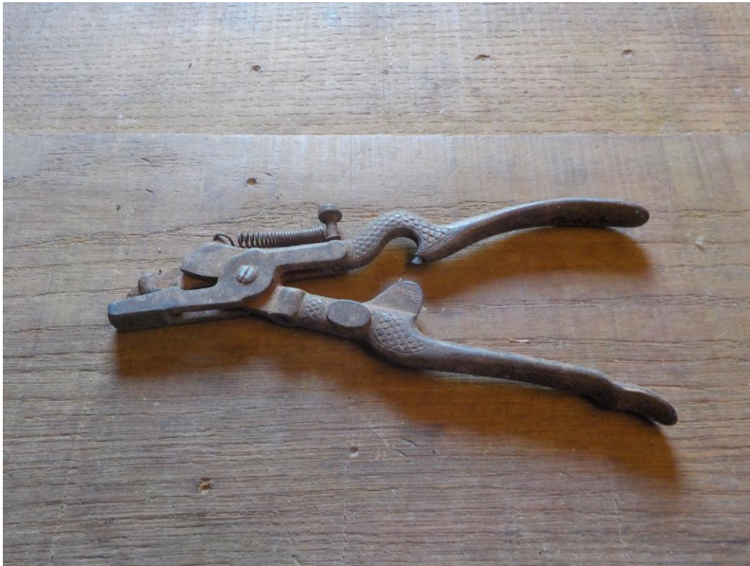
Pince en rapport avec la fabrication des cartouches pour fusil de chasse.
