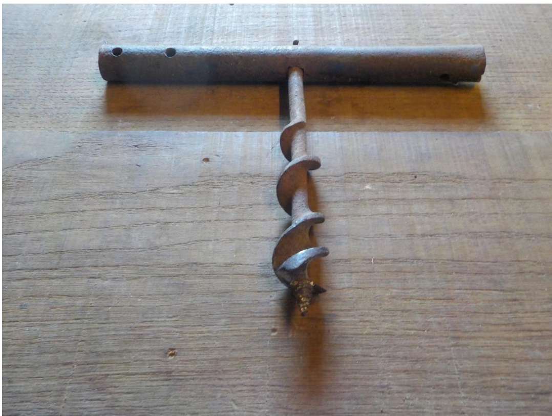
Un percet, peut-être pour percer les trous des pachons d'une échelle, encore qu'il le faudrait d'un diamètre légèrement plus grand.
