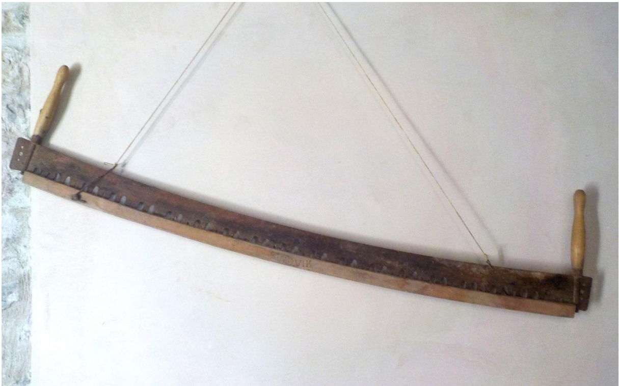
Le passe-partout ou la louve, scie pour abattre les troncs d'arbres et ensuite les débiter.
