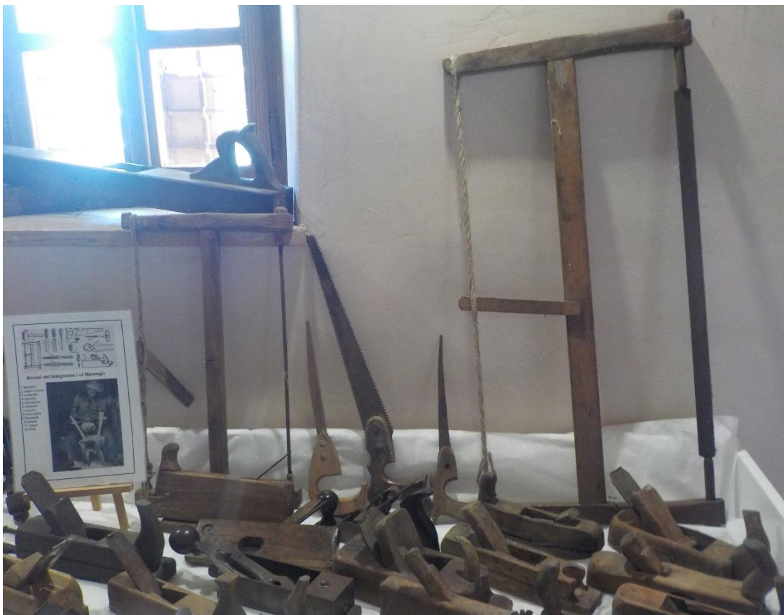
Scie à cadre, varloppes, rabots divers et petites scies queues de rat.
