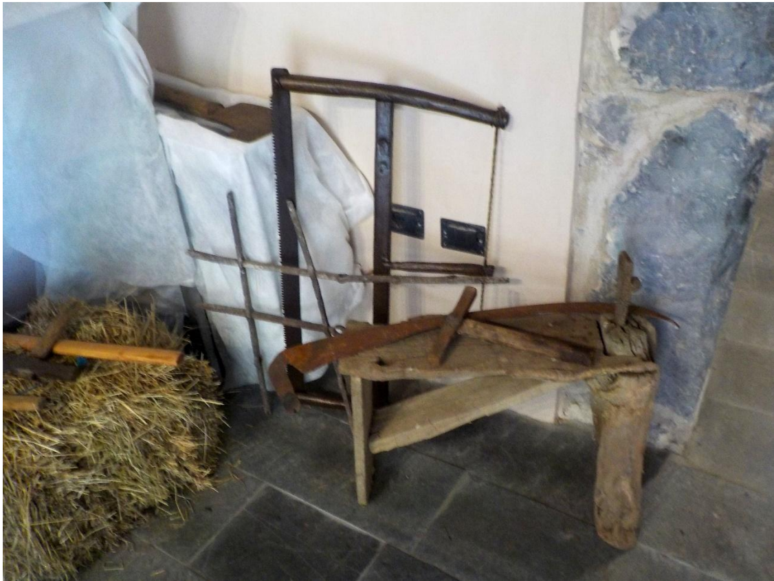
Banc à enchapler, lame de faux, scie à cadre, marteau à enchapler soit battre la lame de la faux après usage.
