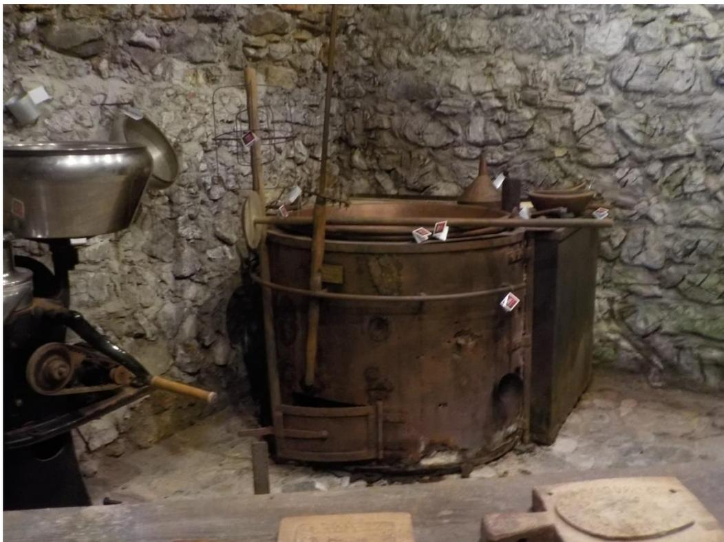
Une époque plus moderne pour la fabrication du fromage dans la grosse chaudière entourée comme un peu dans le Jura par l'entourage de chaudière en fer. La centrifugeuse à gauche. Un débattoir et une lyre. La fabrication du fromage selon des techniques somme toute assez similaires s'effectue dans tout l'arc jurassien et alpin. .
