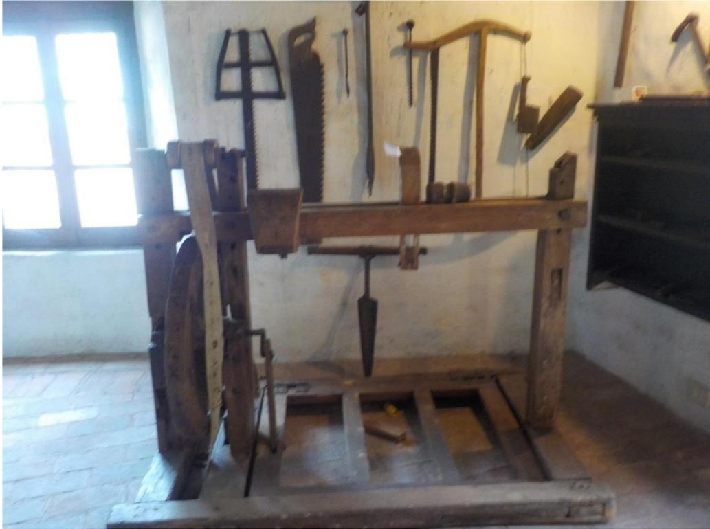
Quelques objets antiques, Le grand châssis avec roue, doit être un tour à bois. Contre le mur scie individuelle, percets, scies à cadre. Dessous perçet ou tarière pour percer les moyeux des roues de char.
