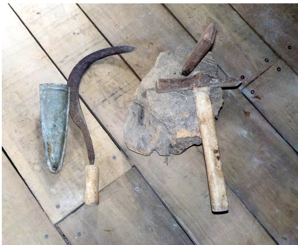
Serpette, cova sans la pierre à aiguiser, plot et fer et marteau à enchapler.
