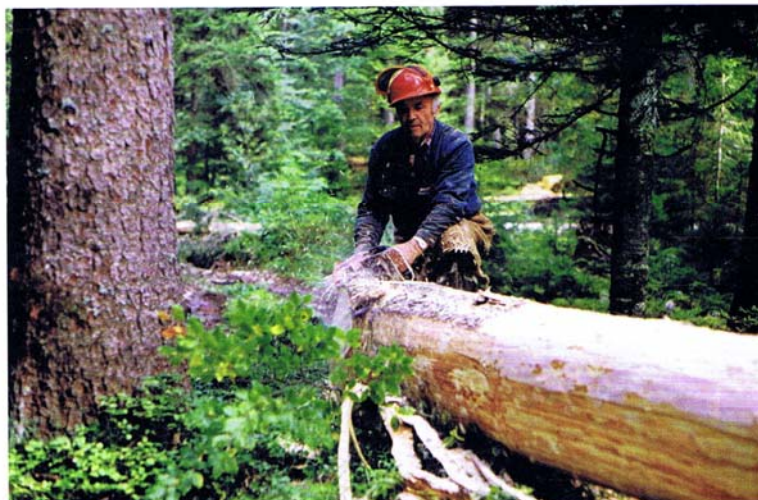
On écorce à la hache, au plumet ou directement à la tronçonneuse quand l'écorce est dure et irrégulière.
